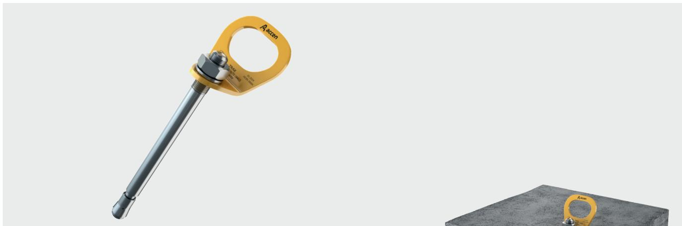
Der Anschlagpunkt TRAX Light für die Anwendung als Anschlagpunkt zur Absturzsicherung für drei Personen gleichzeitig. Erhältlich sind die Montageoptionen für Stahlbeton (min. C20/25), Holzbalken (Minstdurchmesser 13/10 cm oder 13/11 cm) und Stahl (Minstdicke = 5 mm).
